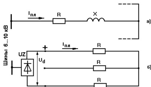
Рис. 2.1. Принципиальные схемы плавки гололеда переменным (а) и постоянным (б) током
