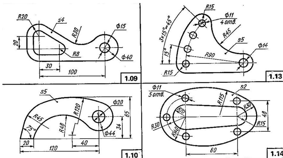
Б) По заданному чертежу построить 3D-модель детали, используя операции «Копирование» и «Симметрия»:
